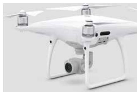
Veículos utilizados para recolha de dados de dinâmica costeira na restinga do Douro: veículo terrestre MMS (Mobile Mapping System) com câmaras fotogramétricas digitais e veículo aéreo não tripulado (UAV) ou drone multi-rotor. Vehicles used for data collection of coastal dynamics in Douro Spit: MMS (Mobile Mapping System) ground vehicle with digital photogrammetric cameras and drone or multi-rotor unmanned aerial vehicle (UAV).
